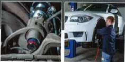
Bilstein Clubsport heißt: Gewindefahrwerk, vielfach einstellbar
